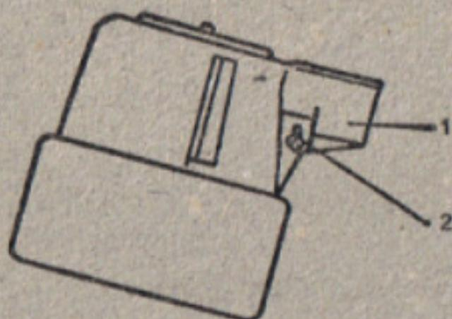
1. Leuchte auf Mastzopf ( $\varnothing$  48, 100 lang) auf-schieben, ausrichten und mit Sechskantschraube M 8 (2) festspannen.
